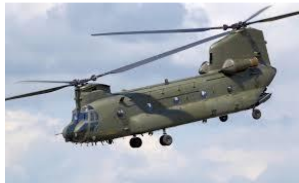
Слика 6. Коаксијални ротори “Камов Ка-50” Слика 7. Тандем ротори “СН-47 Chinook”
