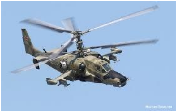
Слика 6. Коаксијални ротори “Камов Ка-50” Слика 7. Тандем ротори “СН-47 Chinook”
