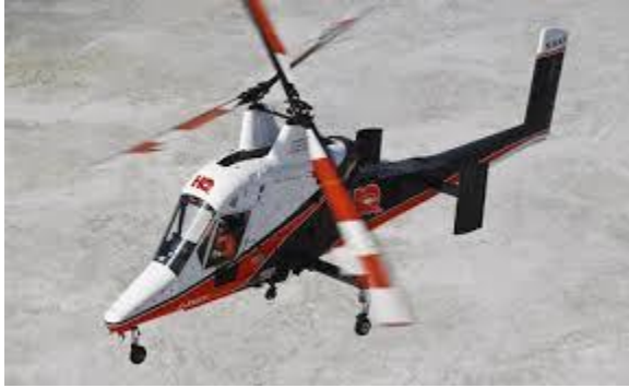
Слика 5 Синхронизирани ротори на хеликоптер “Kaman K-MAX”
